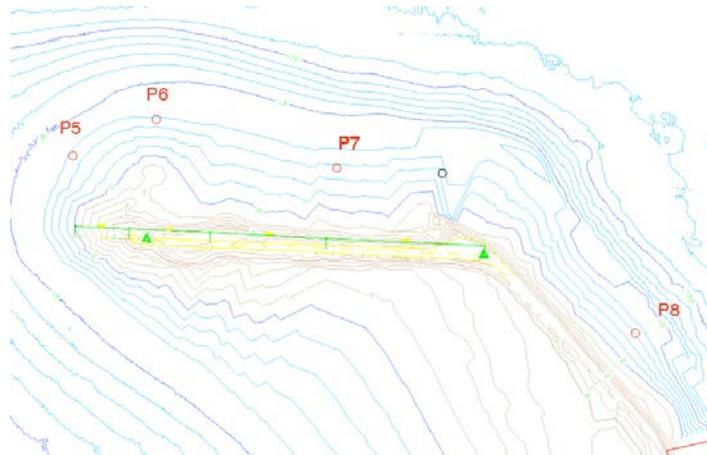
Figura 33. Localización de los nodos afectados por la difracción del oleaje
