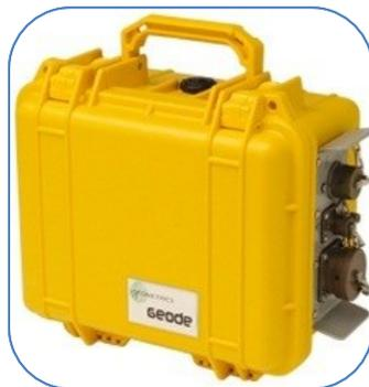
**Foto 3. Equipo de Refracción Sísmica: Geode de la casa Geometrics.**
