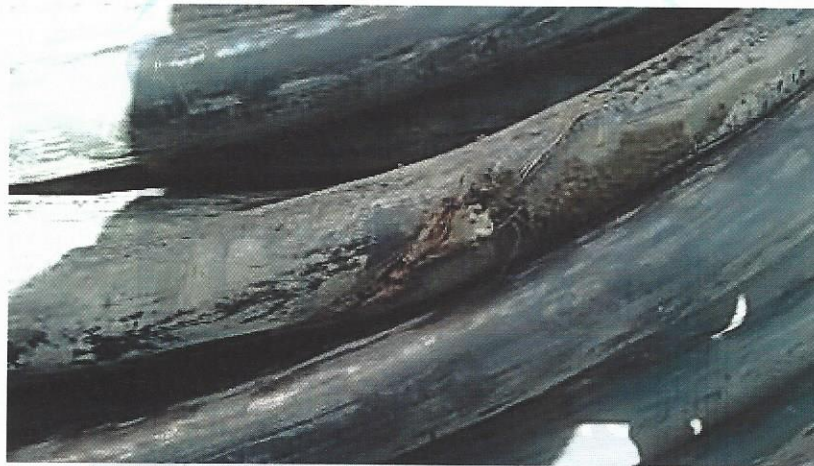
Figura 56. Cable en mal estado que se sustituyó
