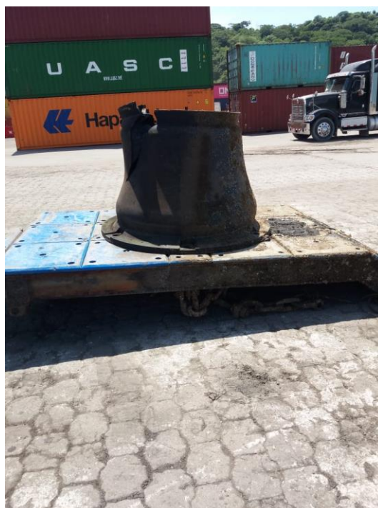
Figura 21. Estado defensa y cono que se sustituyeron
