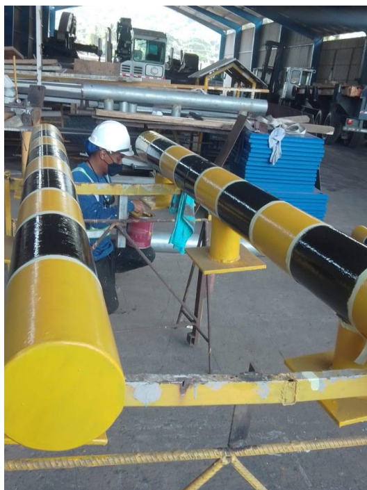
Figura 19. Trabajos de confección guardarruedas
