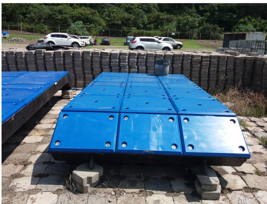
Figura 22. Defensa con baquelitas instaladas y lista para montaje
