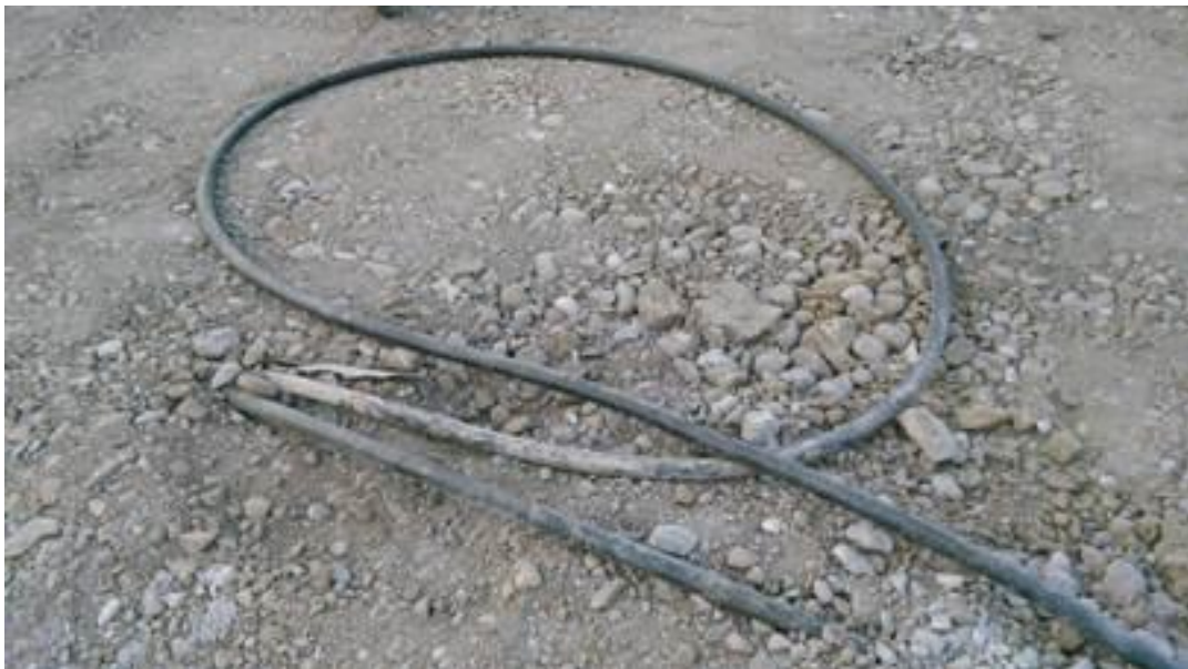
Figura 18. Cable media tensión dañado
