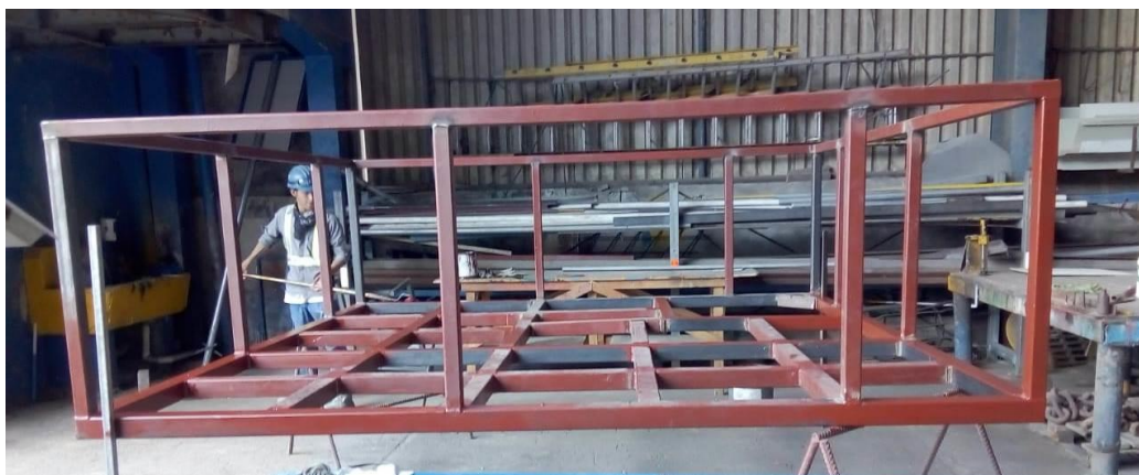
Figura 36. Construcción de canasta para torres
