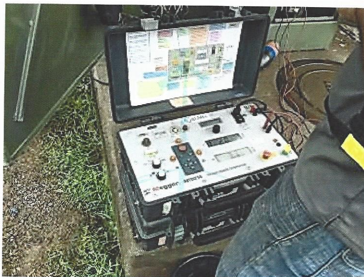
Figura 43. Mantenimiento banco de transformadores pruebas 2
