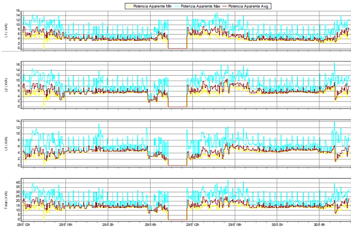
Figura 5-3: Potencia aparente en el interruptor principal de la sección de mantenimiento.
