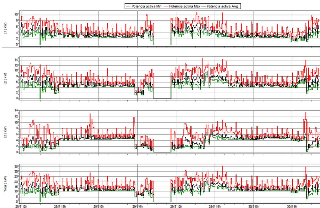
Figura 5-1: Potencia activa en el interruptor principal de la sección de mantenimiento.
