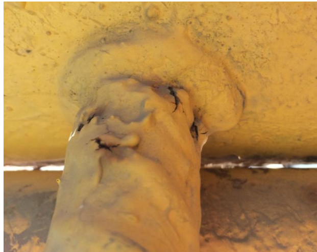
Figura 9. Soldaduras en mal estado
