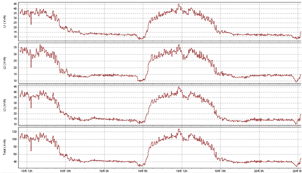
Figura 2-3: Potencia aparente en la transferencia de alimentación principal del edificio administrativo.
