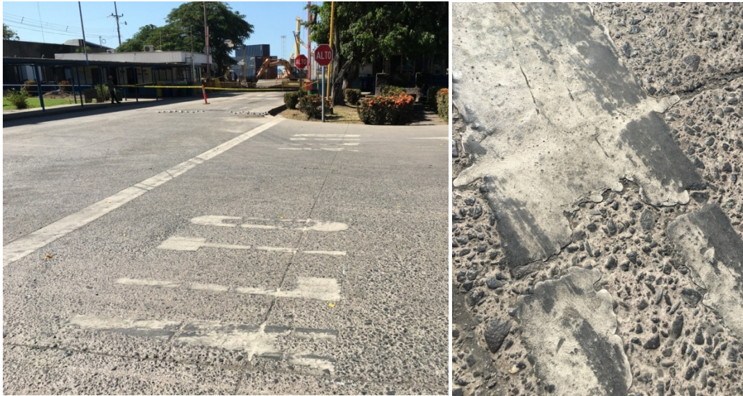
Figura 392. Prueba de señal de "ALTO" con pintura termo plástica.
