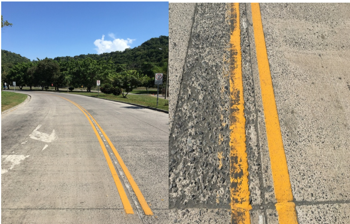
Figura 381. Prueba a líneas de centro de calle con pintura termo plástica.
