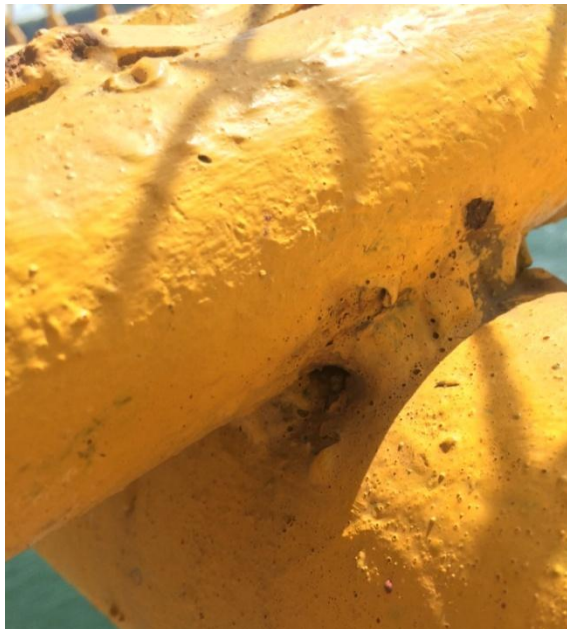
Figura 9. Soldaduras porosas y mal confeccionadas
