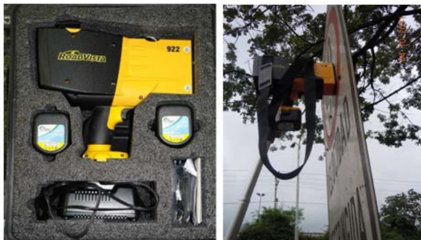
Figura 50. Equipo de prueba de retrorreflectividad vertical
