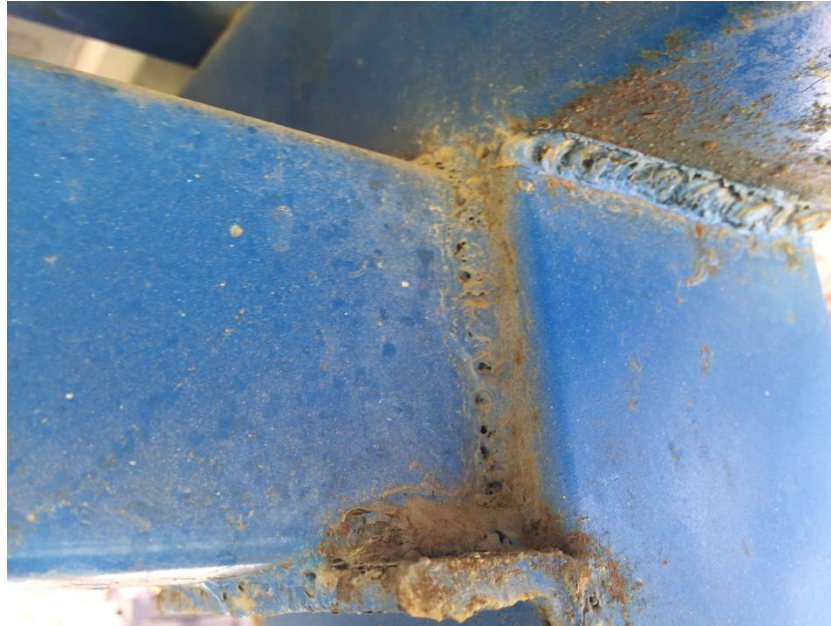
Figura 5. Soldaduras en mal estado
