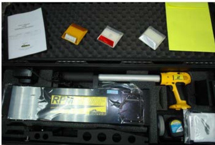
Figura 37. Retrorreflectómetro para captaluces Fuente: (Zamora, 2014)
