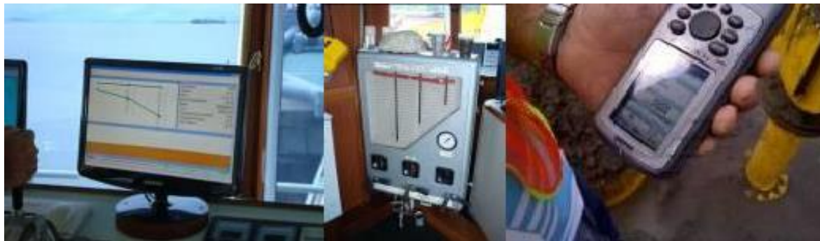
Figura 3. Parte del equipo de cómputo, con el que se maneja y controla las profundidades y el sitio de depósito. Ejemplo del último dragado realizado
