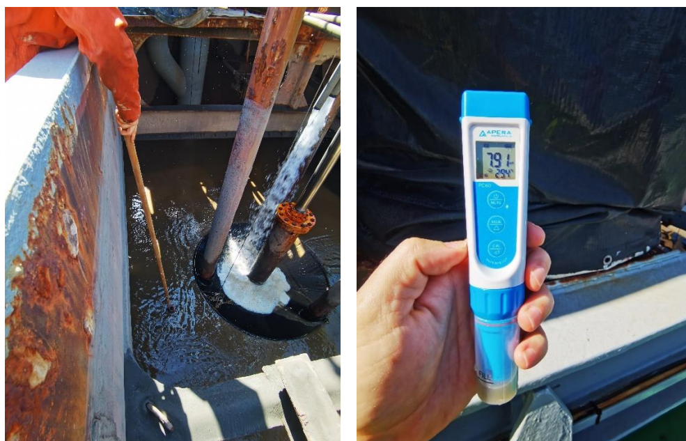
Figura N. 15 Mediciones Multiparámetro (Izq.) Toma de Muestra (Der.) Equipo de medición Fuente: Fotografías de Millán Ingeniería
