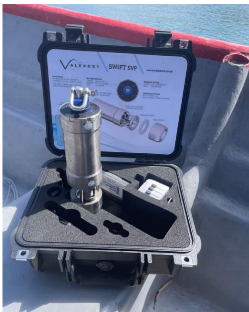
Figura N. 17 Calibraciones de Velocidad del Sonido (Izq.) Perfilador SVP (Der.) Plato “bar check” Fuente: Fotografías de Millán Ingeniería
