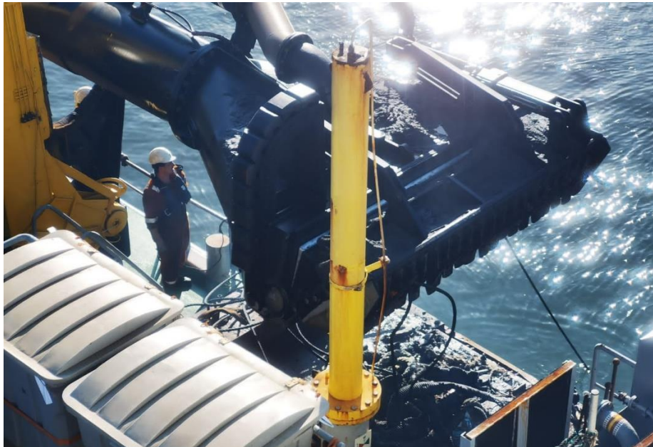
Figura N. 4 Cabezal de carga Draga ELBE Fuente: Fotografía tomada por Millán Ingeniería
