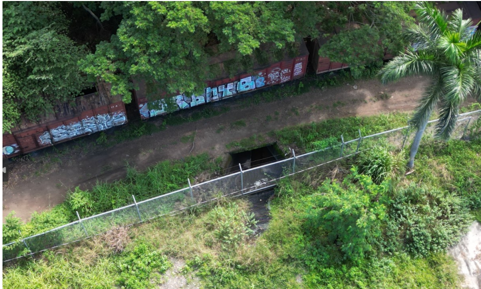
Figura 7. Alcantarilla para el manejo de aguas en el camino de acceso; obstruida por material vegetal y basura
