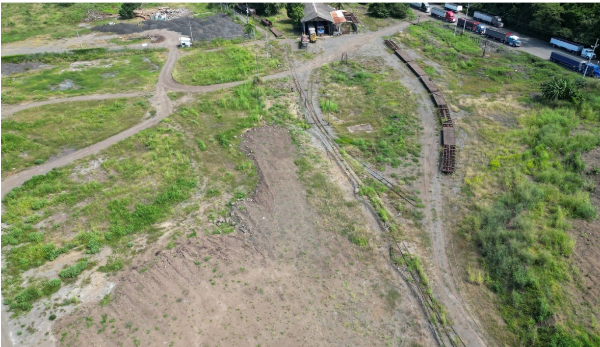
Figura 35. Zona de rellenos antropogénicos en la Zona I: arcillas, arenas y gravas dispuestas heterogéneamente
