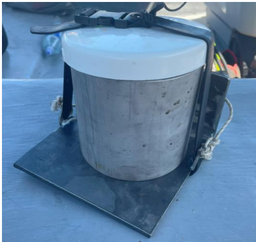
Figura N. 22 (Der.) Aditamento para “densidad in-situ” (Izq.) Muestras granulométricas en laboratorio [Ref. Tomadas por (Izq.) Luis Millán (Der.) M y V Soluciones Geotécnicas]
