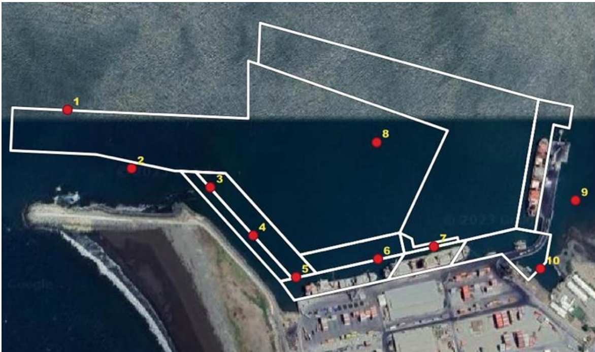
Figura N. 6 Ubicación de los puntos de tomas de muestras para análisis del sedimento. [Ref. Elaboración propia con datos del Pliego de Condiciones]
