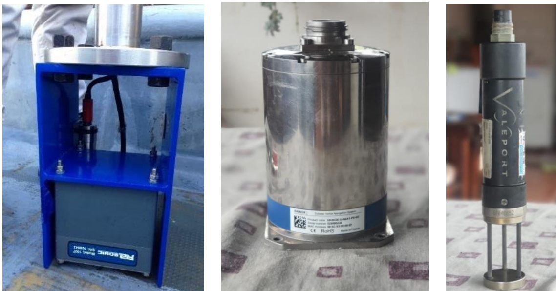
Figura N. 2 (Izq.) Sensor ecosonda multihaz (Cen.) Sensor de Movimiento (Der.) [Ref. Fotografías (Izq.) Luis Millán, (Cen.) (Der.) Jimmy García]
