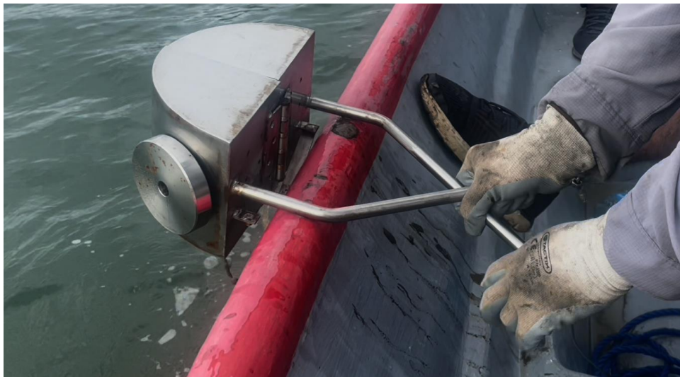
Figura N. 23 Toma de muestras químicas y microbiológicas por medio de draga [Ref. Tomada por Luis Millán]
