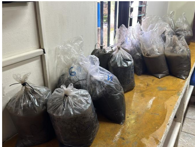
Figura N. 22 (Der.) Aditamento para “densidad in-situ” (Izq.) Muestras granulométricas en laboratorio [Ref. Tomadas por (Izq.) Luis Millán (Der.) M y V Soluciones Geotécnicas]
