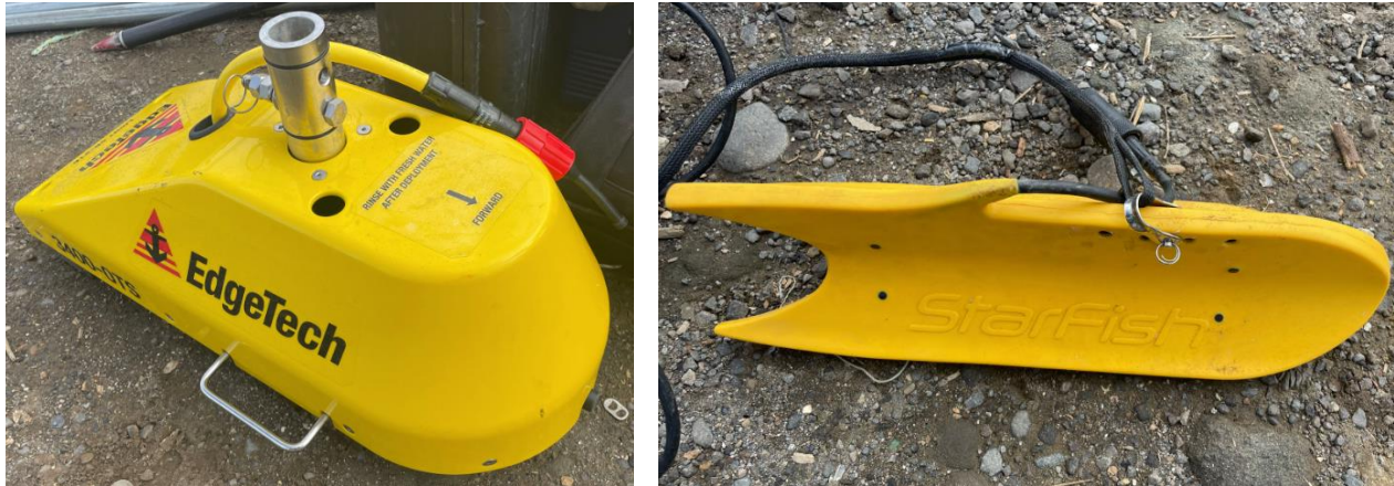
Figura N. 4 (Izq.) Perfilador de fondo Edgetech 3400 OTS (Der.) Escáner Lateral Starfish 452F [Ref. Fotografía de Luis Millán]
