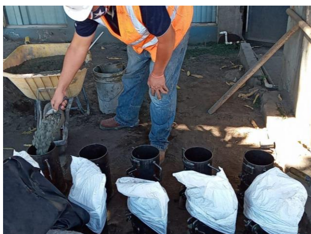
Figura 19. Cilindros para control de calidad del concreto
