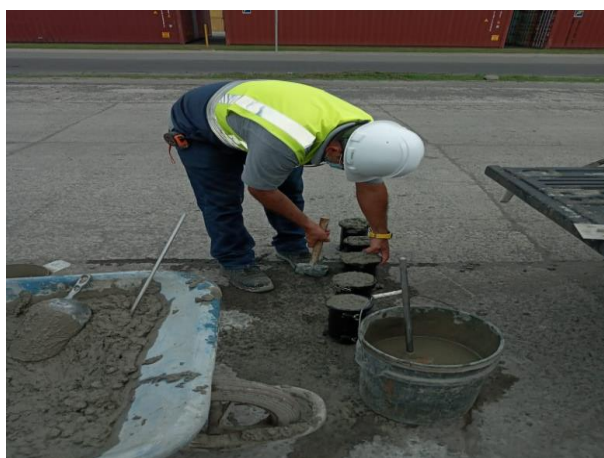
Figura 26. Cilindros para control de calidad del concreto
