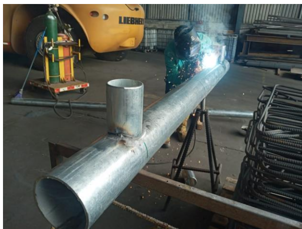
Figura 27. Trabajos de confección guardarruedas
