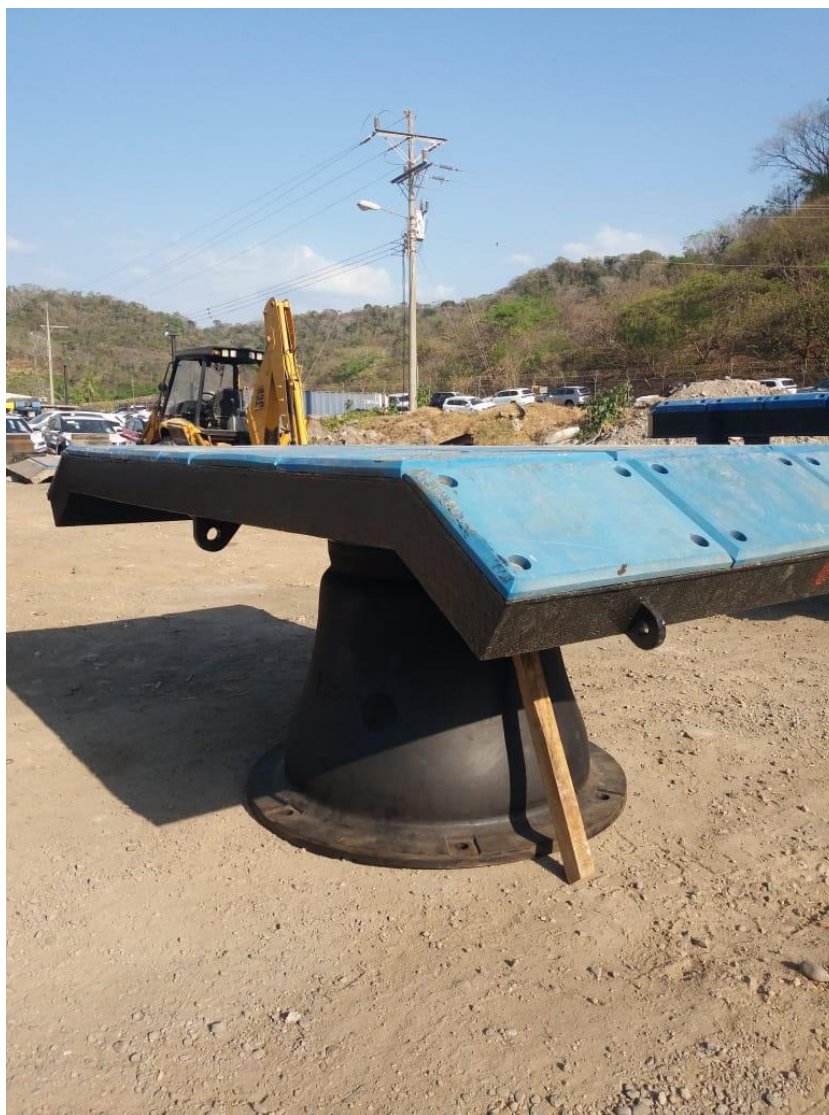
Figura 23. Defensa con baquelitas instaladas y lista para montaje
