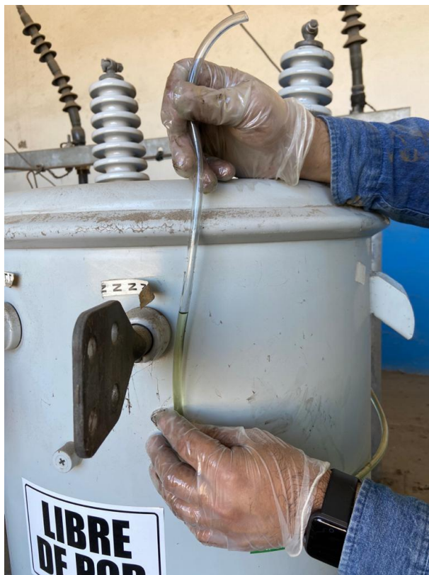
Figura 13. Extracción de aceite para pruebas de laboratorio
