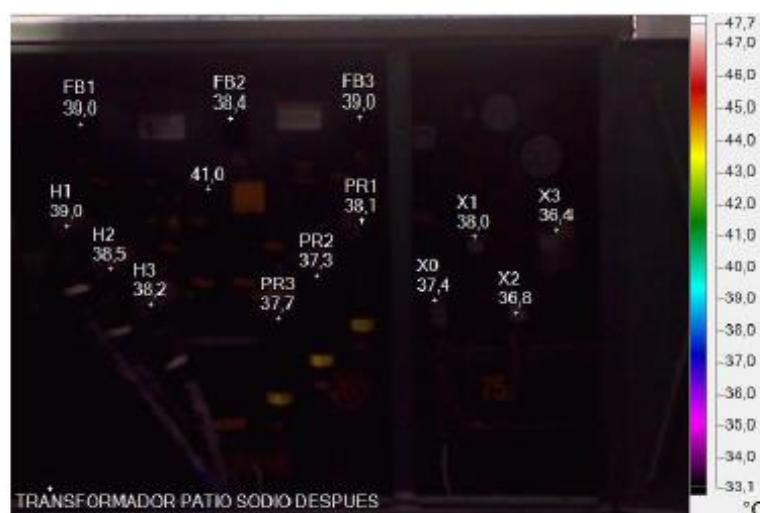
Figura 11. Mantenimiento bancos de transformadores termografía
