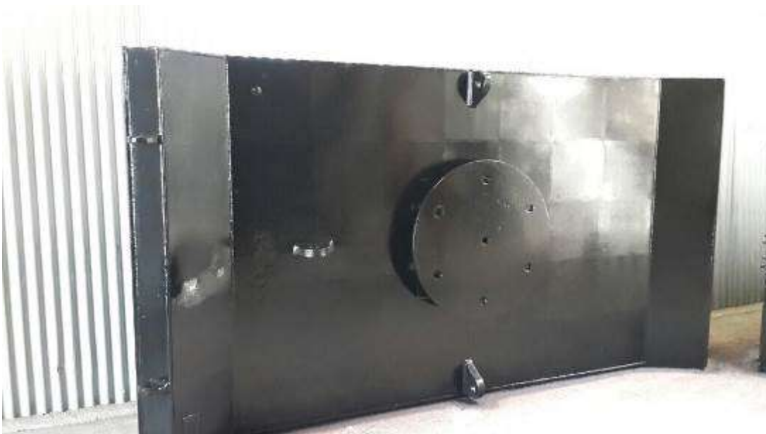
Figura 38. Panel de defensa marina con mantenimiento de pintura finalizado.
