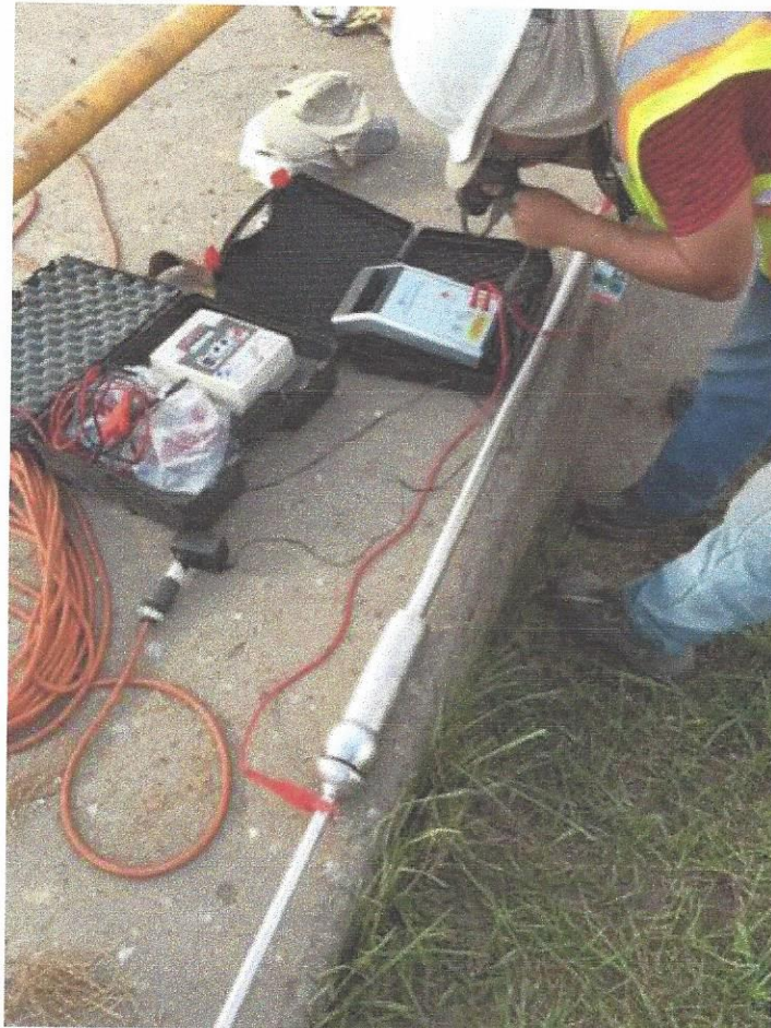
Figura 58. Mantenimiento sistema contra descargas atmosféricas prueba pararrayo
