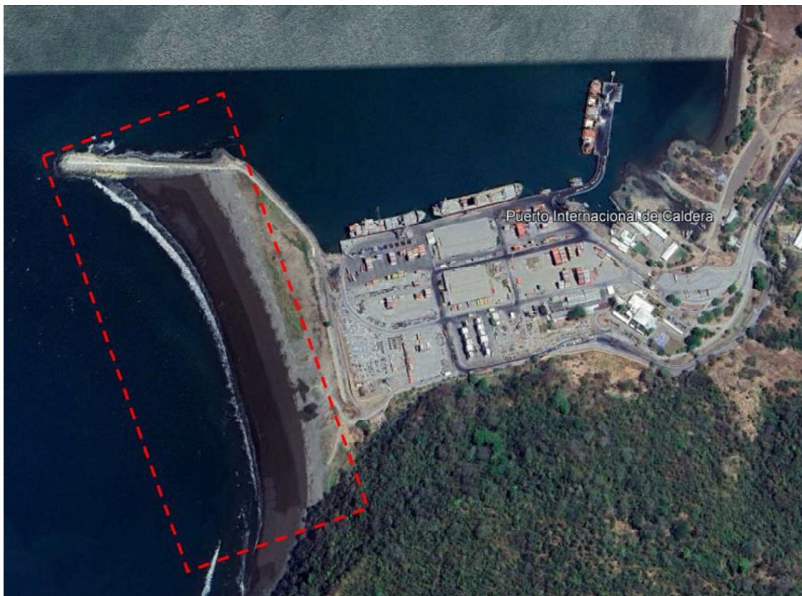
Figura 2.212: Terminal Puerto Caldera – Sedimentos en Rompeolas
