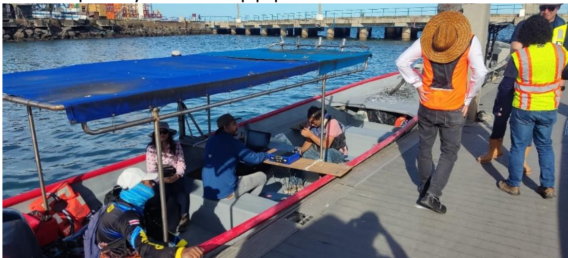
Figura N° 5. Preparación y calibración de equipo previo a la batimetría en Puerto Caldera.
