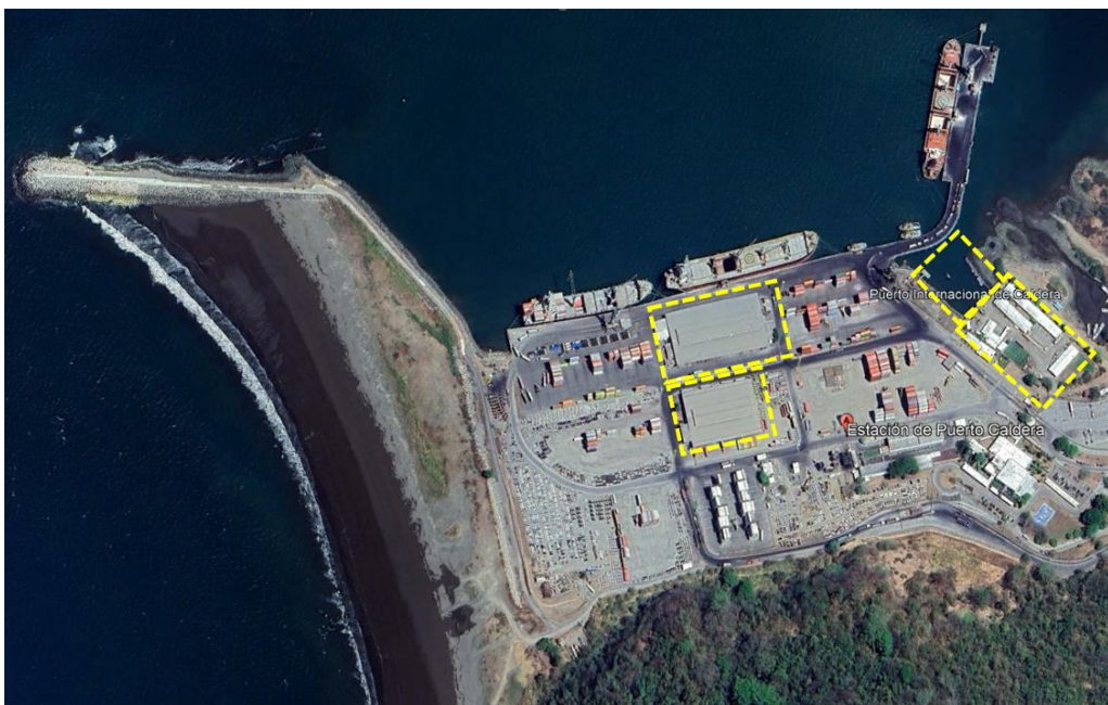
Figura 2.261: Ubicación de las Demoliciones Propuestas
