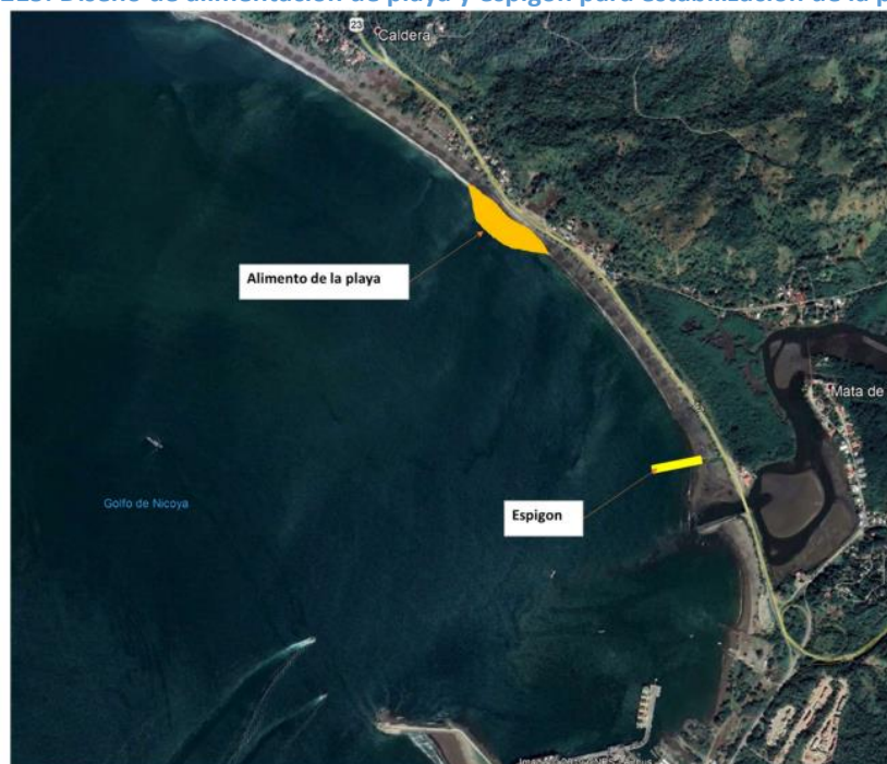
Figura 2.215: Diseño de alimentación de playa y espigón para estabilización de la playa
