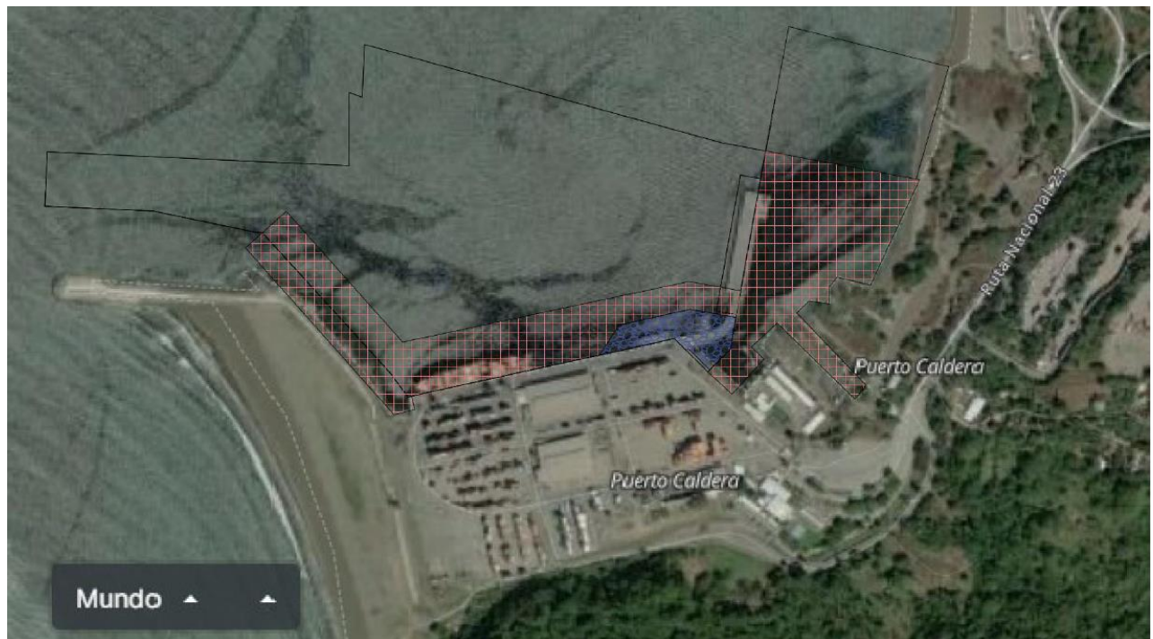
Figura 2.182: Zona de extensión del levantamiento tipo SBP y SSS (zona cuadriculada)
