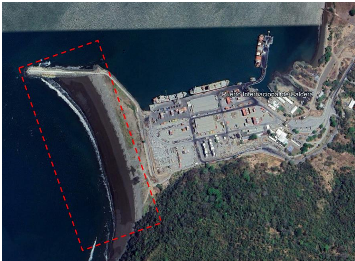
Figura 2.212: Terminal Puerto Caldera – Sedimentos en Rompeolas
